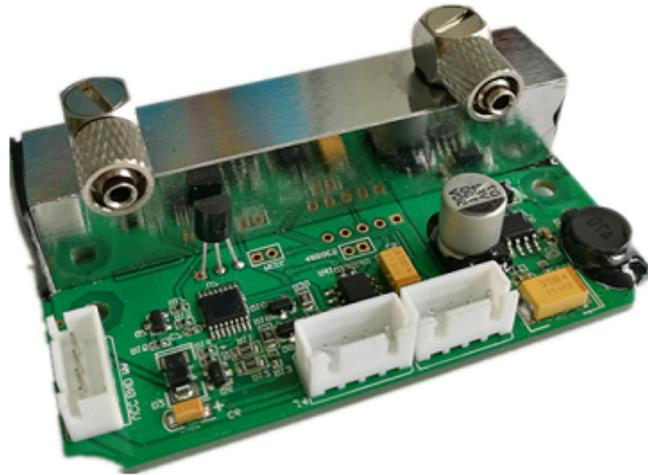
INFS320DP是一款多气体传感器模组，可以同时检测sf6和O2两种气体。sf6采用NDIR红外吸收检测原理。O2采用电化学原理。该模组采用MEMS光源、特殊结构的光学腔体和双通道探测器，实现空间双光路参比补偿，微处理器进行信号采集、处理和输出。INFS320DP具有很好的选择性，高灵敏度，寿命长，低功耗；内置温度传感器，可进行温度补偿；采用485输出。1. 工作条件描述符号数值单位储存温度Tstg-20to50°C工作温度TA-20to+50°C工作湿度HA15to90%RH无凝结工作压力PA0.8to1.2atm
